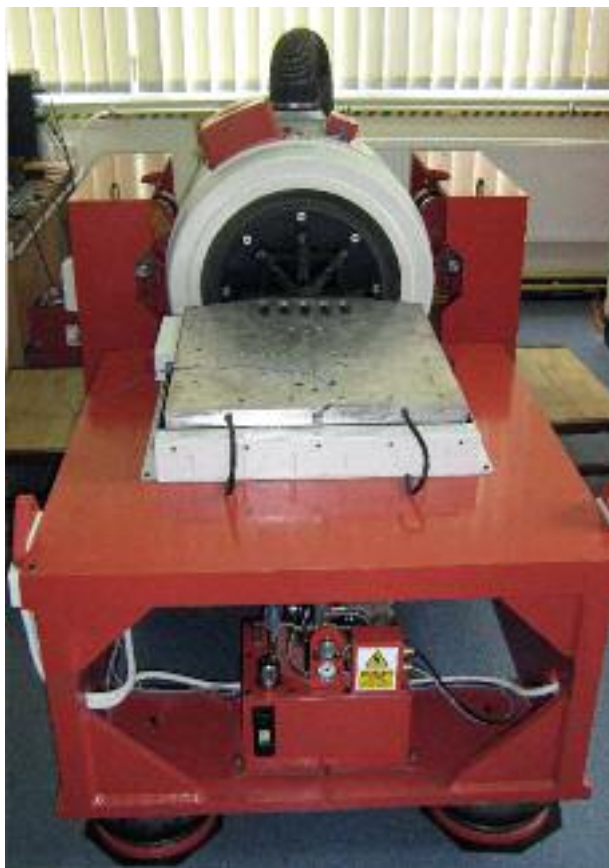
Wstrząsarka wibracyjna LDS 850-V440
