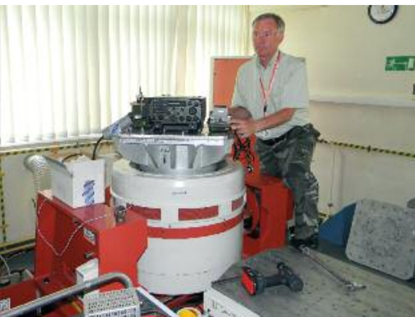
Montaż obiektu badań na wstrząsarce wibracyjnej
