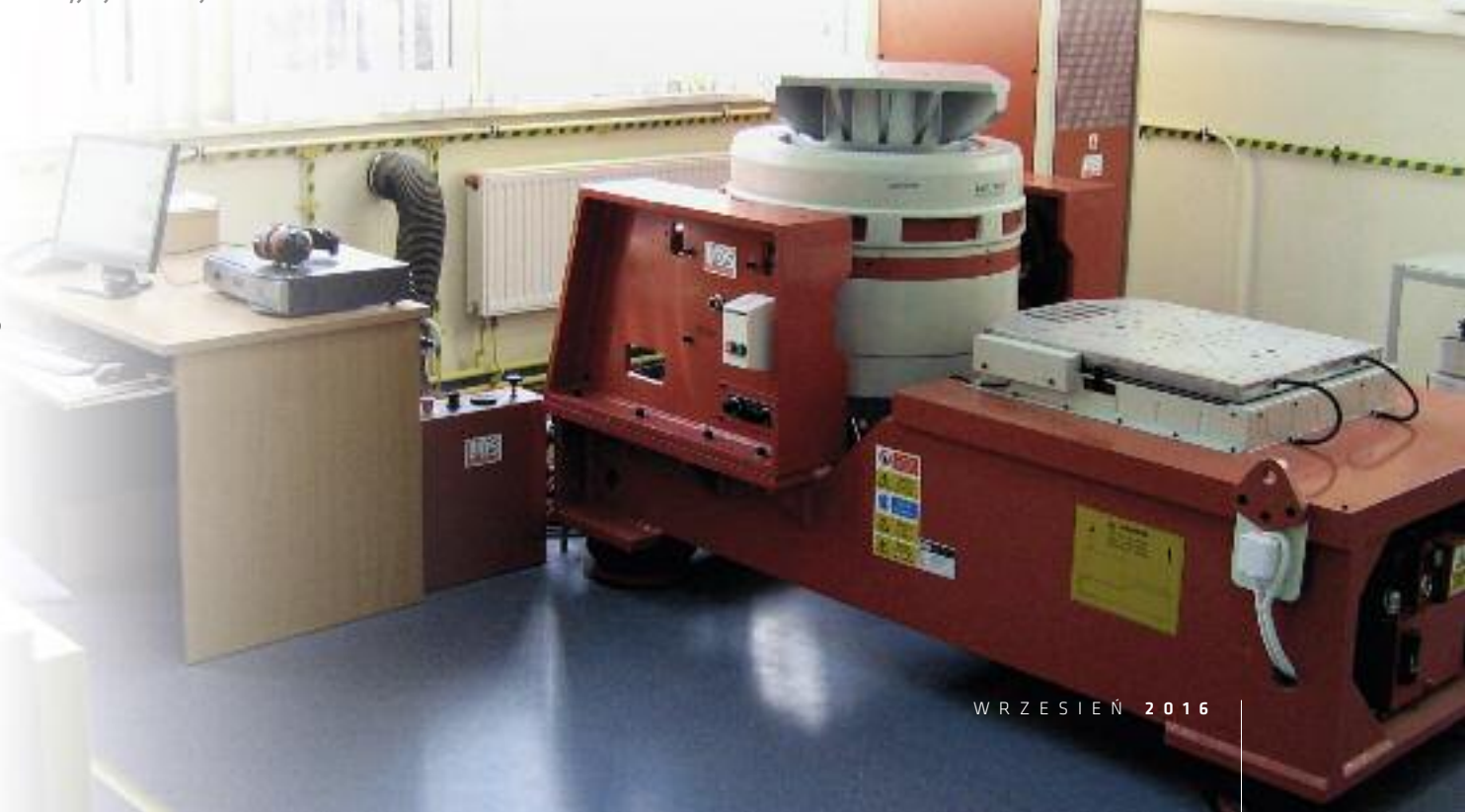
Stanowisko do wykonywania badań odporności wibracyjnej i udarowej
