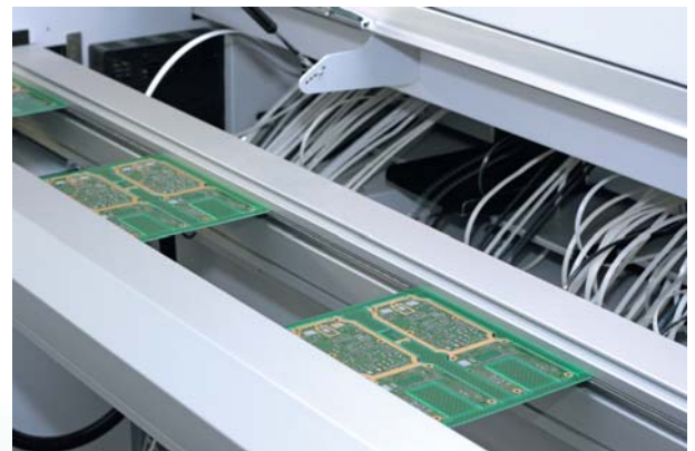
Montaż elementów na automacie do SMD
