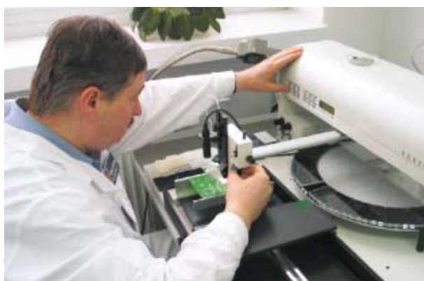
Urządzenie Expert służy do wykonywania montażu modeli, prototypów i nietypowych bloków urządzeń
