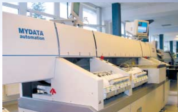
Nowoczesna linia do montażu powierzchniowego elementów
