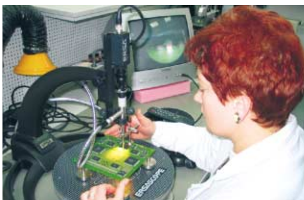
Istotnym elementem kontroli jakości procesów technologicznych jest system wizyjnej kontroli układów
