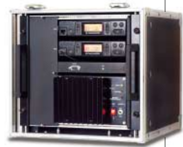
Stacja retransmisyjna ZT3801-160
